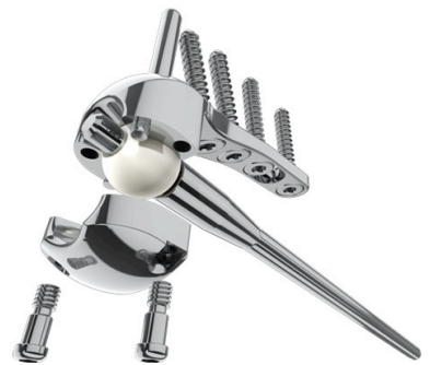
De componenten voor de APTIS prothese. Op het spaakbeen wordt een plaat vastgezet met schroeven. In de ellepijp wordt een steel in de mergholte geplaatst. Hierop wordt een balletje geplaatst. De ellepijp en spaakbeen worden verbonden met een koppelstuk.
